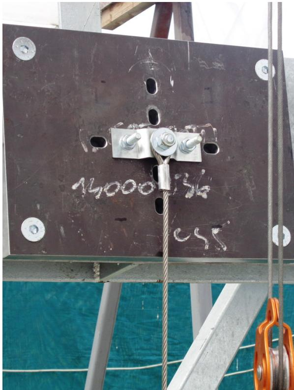
Allestimento del campione in prova - direzione con cavallotto in orizzontale
