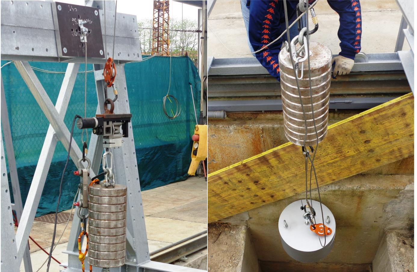
Particolare allestimento prova dinamica (a sinistra) e integrità (a destra)
