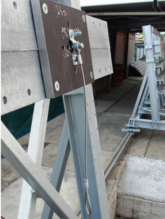
Allestimento del campione in prova - direzione con cavallotto in verticale
